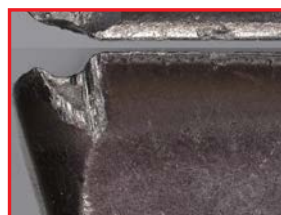
Longitud de corte de 1,0 m
